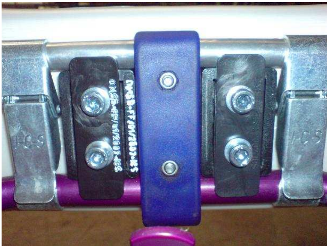
Foto des Frontspoiler montiert am Chassis mit Sicht auf die Befestigung Photo of front bumper mounted at the chassis in view to the support
